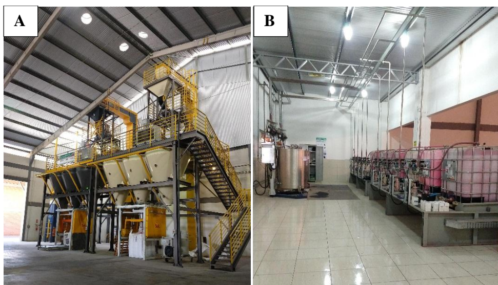
Figura 8 - Centro de tratamento de sementes industrial (A), IBCs com produtos para o preparo de calda e dosadores (B)
