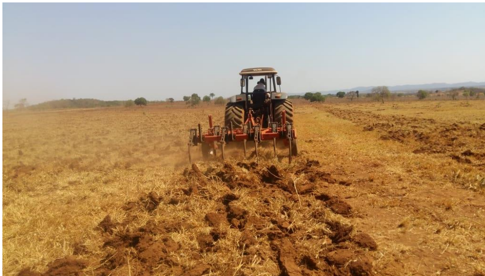
Figura 12 - Operação de subsolagem do solo, Faz. da Lupa Agrícola, Israelândia-GO.
