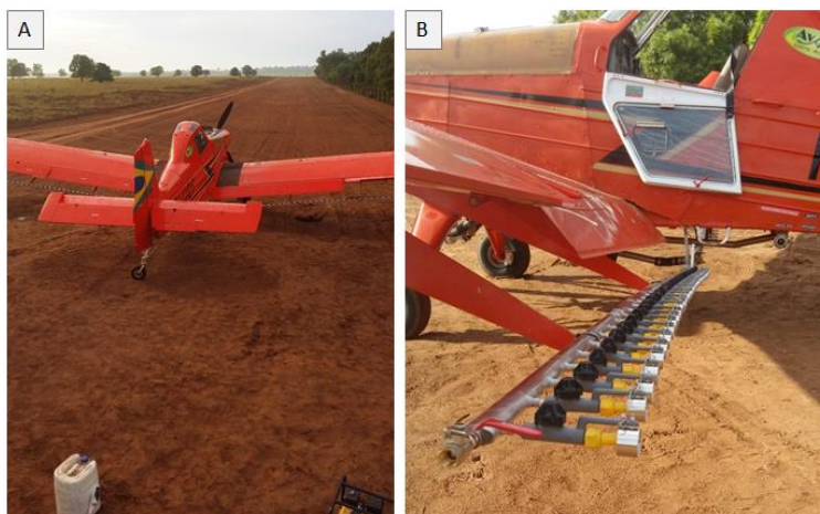
Figura 25 - Aeronave PT-UOF utilizada na aplicação (A), barra de pulverização eletrostática (B).
