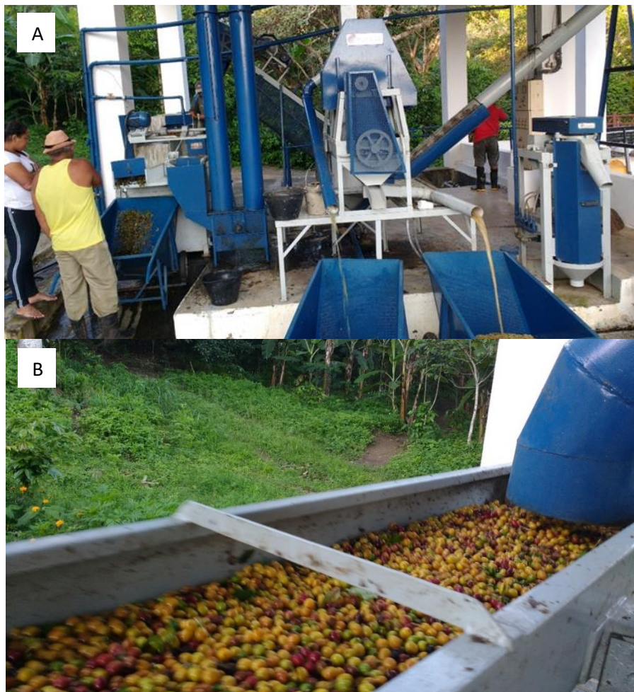
Figura 17 - Lavador, unidade de beneficiamento (A), etapa de limpeza, remoção de folhas e galhos (B)
