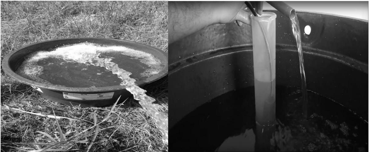
**Figura 12.** Teste de vazão de campo e volume succionado pelo venturi com proveta graduada
