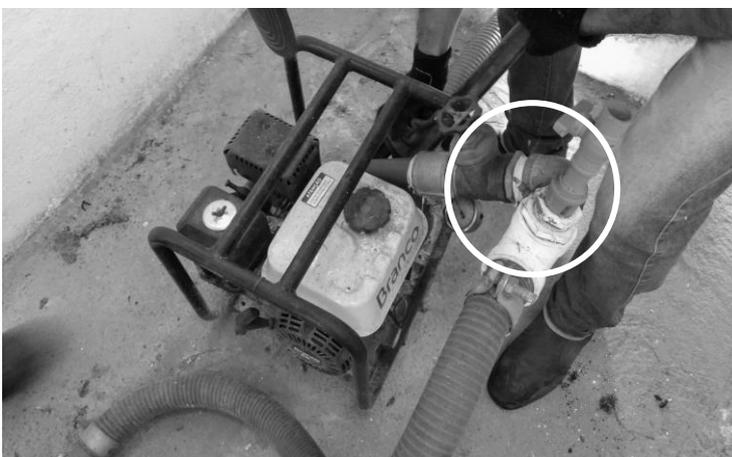
**Figura 9.** Em destaque conexão desnecessária eliminada da saída de recalque da bomba
