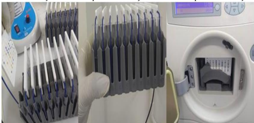
Figura 39. Utilização do Vitek 2 para identificação de bacterias presente nas rações
