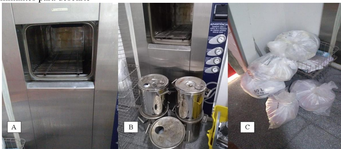
Figura 26. A) Interior da autoclave B) Latões para autoclave C) Sacos identificados como contaminantes para descarte
