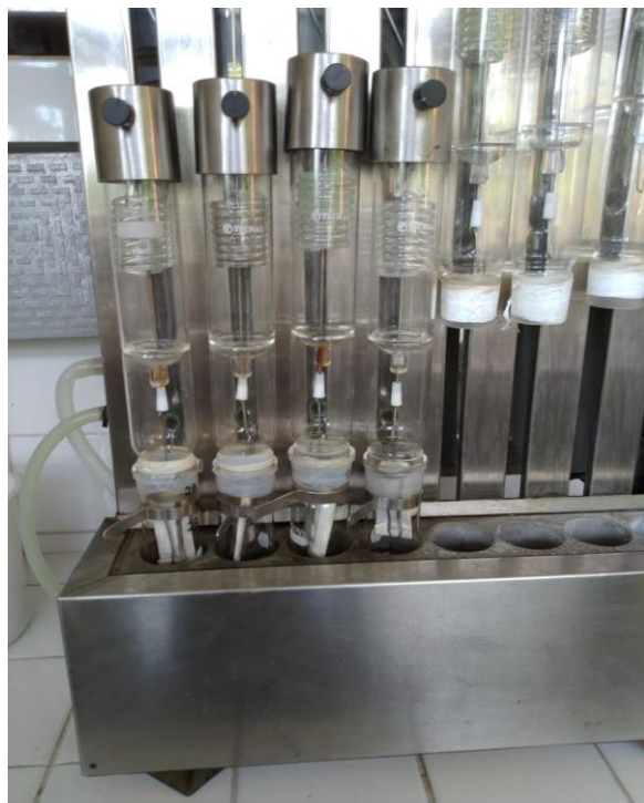
Figura 6: Equipamento soxhlet durante a extração da gordura. Fonte: Arquivo pessoal (2019).
