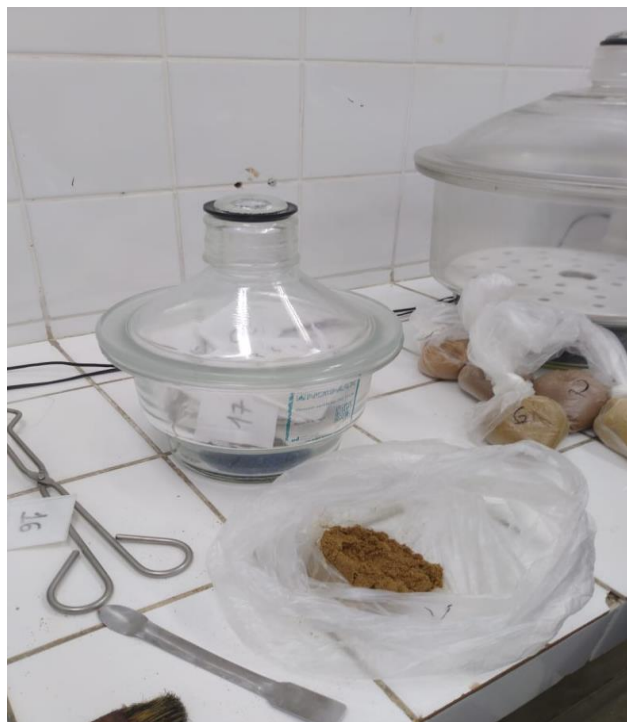
Figura 4: Sacos de TNT após estufa, sendo pesados e pesagem da amostra em seguida. Fonte: Arquivo pessoal (2019).
