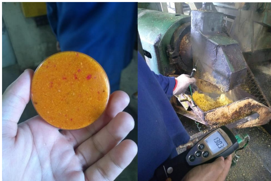
Figura 8. Resultado da análise de atividade Ureática qualitativa e medição da temperatura da extrusora. Fonte: Arquivo Pessoal.
