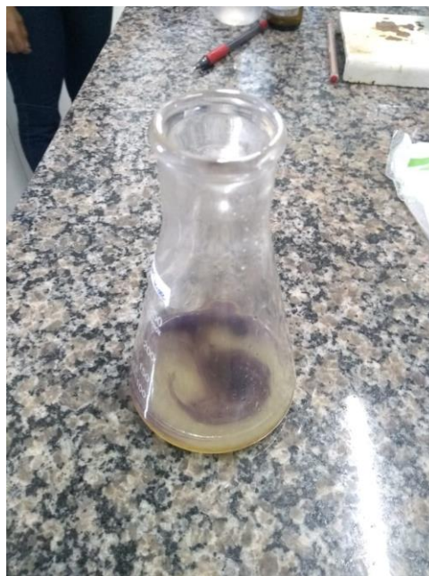
Figura 5. Amostra positiva para peróxido. Fonte: Arquivo Pessoal.
