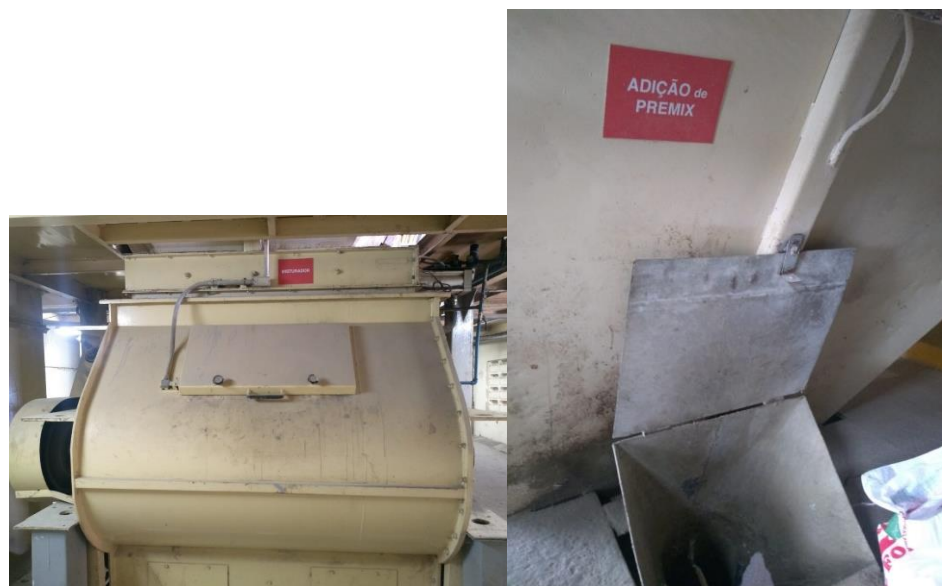
Figura 11. Misturador e local para adicionar o Premix. Fonte: Arquivo Pessoal.
