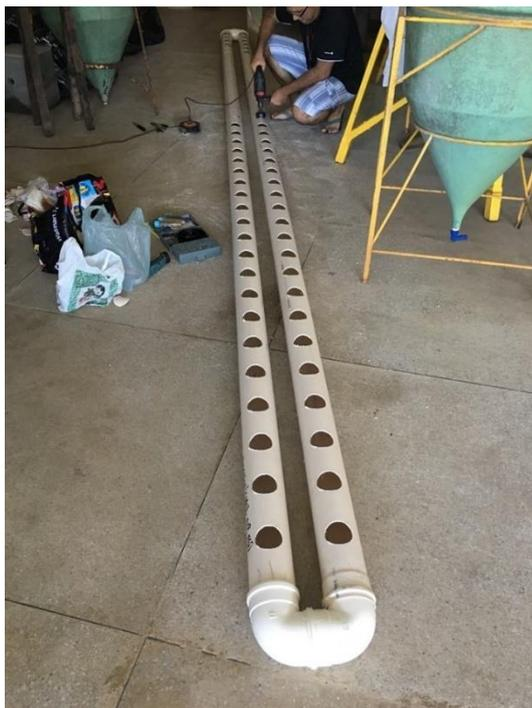
**Figura 3.** Cano de 100 mm com furos para introdução das alfaces
