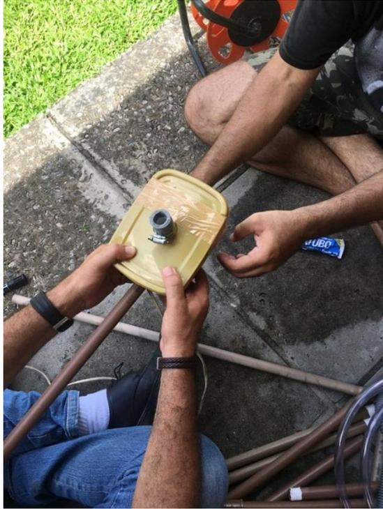
**Figura 7.** Bomba armazenada no pote de sorvete
