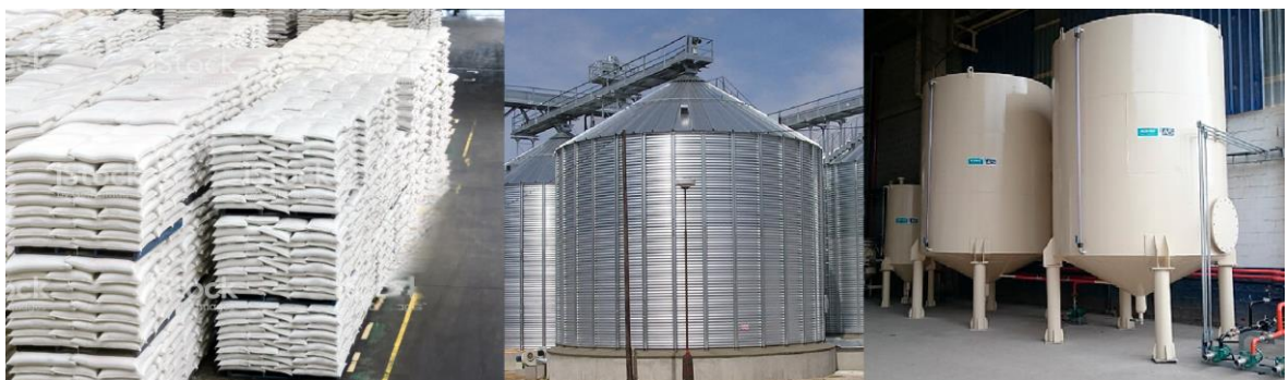
Figura 7. Tipos de armazenamento, da esquerda para a direita ensacado, granel e líquidos
