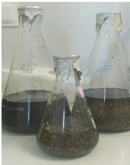
Figura 11. Material seco e triturado de flores e folhas de S. acmella em solução etanólica
