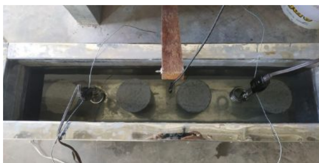
Figura 2: Concreto submerso em água à 70°C.
