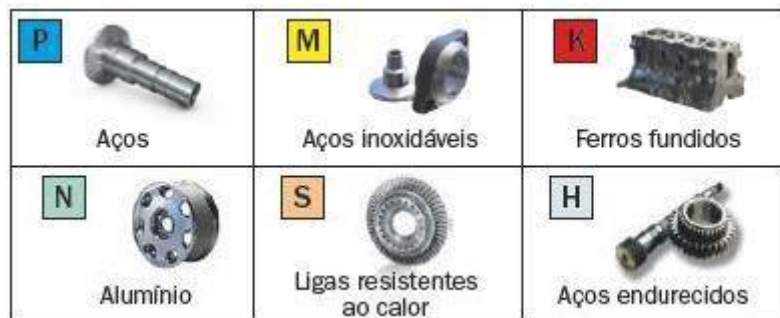
Figura 2. Classificação das cores para os diferentes tipos de materiais a serem usinados por ferramentas de metal duro conforme norma ISO. Fonte: SANDVIK, 2018.
