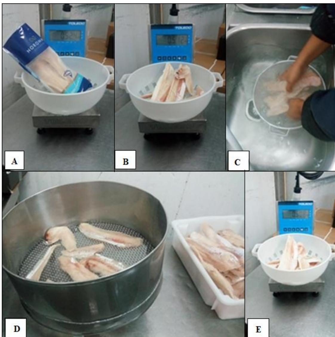
Figura 7. Produto sendo avaliado quanto ao seu peso e índice de glaciamento. A- Produto sendo pesado com embalagem; B- Sem embalagem e com glazing ; C- Tendo seu glaciamento retirado; D- Passando por processo de gotejamento; E- Pesado sem glazing . Fonte: Arquivo pessoal (2018).
