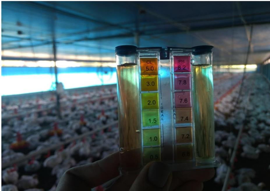
Figura 11 - Teste para avaliar nível de cloro e pH da água.
