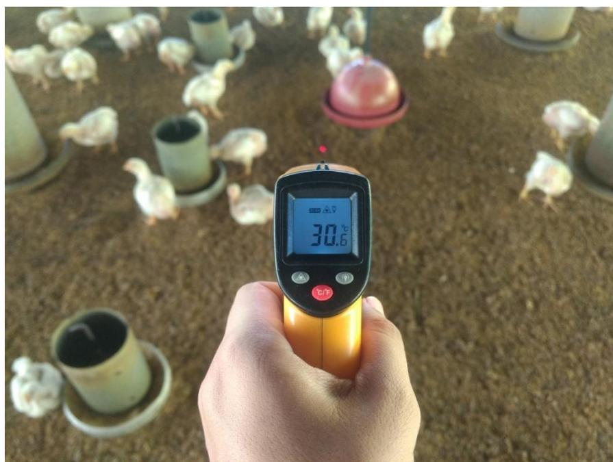
Figura 8 - Avaliação da temperatura da cama - termômetro.
