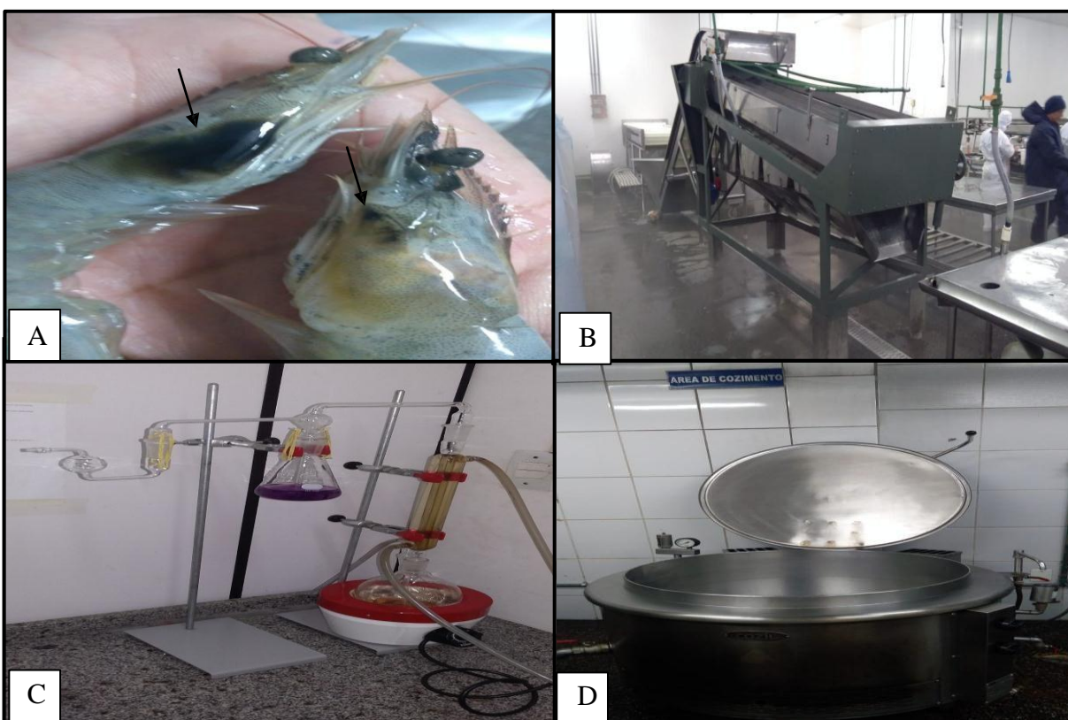
Figura 6 – Camarões cinza ( Litopenaeus vannamei ) apresentando melanose (A); Máquina classificadora de camarão (B); Realização no Monier-Willians no camarão (C); Caldeira para pré-cozimento do camarão (D). Fonte: Arquivo pessoal (2018).
