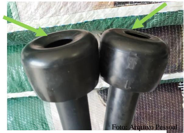
**Figura 8** – Na esquerda teteira com bocal deformado e na direita uma teteira sem uso.
