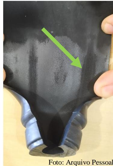
**Figura 6** – Estrias no interior do corpo da teteira.
