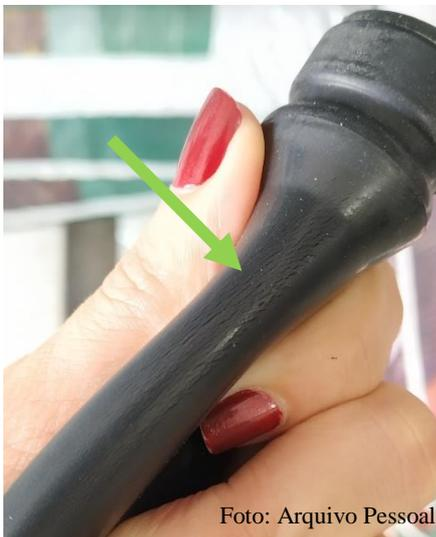
**Figura 5** – Estrias no exterior do corpo da teteira.
