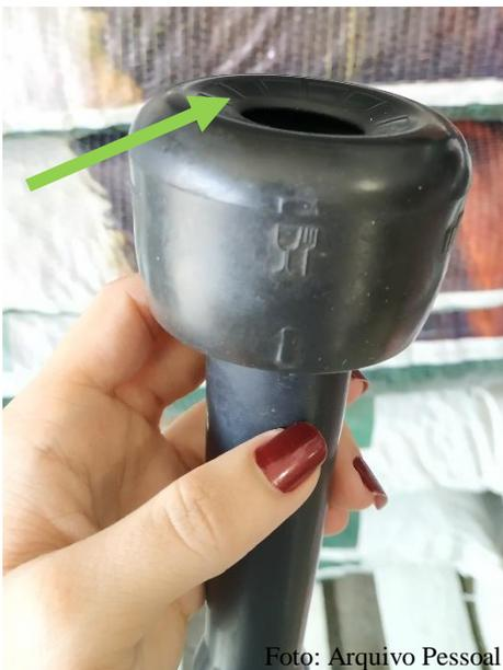
**Figura 7** – Deformação de Bocal.
