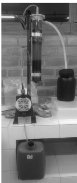
Figura 5 - Sistema reator UASB experimental.
