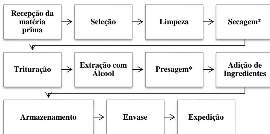
Figura 10 - Fluxograma simplificado do processo de produção de bebidas mistas.
