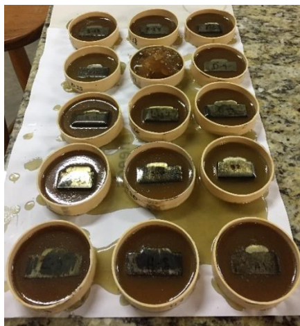
Figura 5 - Amostras embutidas. Fonte: Autor.
