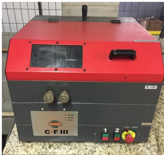
Figura 4 - Cortadeira utilizada no corte dos corpos de prova. Fonte: Autor.
