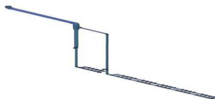
Figura 08: Sistema de instalação hidráulicas do muro sustentável.
