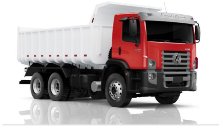
Figura 18. Caminhão caçamba Volkswagen modelo Constellation, tração 6x4. Fonte: Volkswagen.
