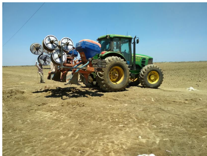
Figura 11. Trator modelo 6145J da John Deere munido do implemento sulcador duplo, com adubação e instalação automática das mangueiras de gotejo.
