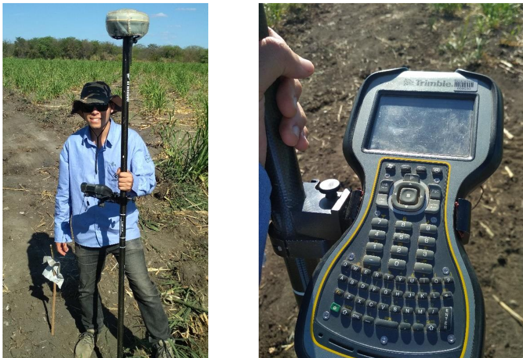
Figura 8. Receptor Móvel Trimble R8s, bastão de suporte para elevar a antena a 2m (a esquerda), e coletora para navegação (a direita).
