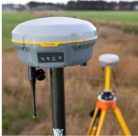
Figura 9. Receptor GPS RTK Trimble R8s, base e rover. Fonte: trimble.com.
