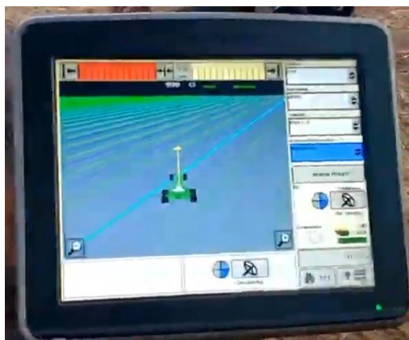
Figura 35. Linhas de sulco importadas e projetadas pelo Piloto GS3 no painel.
