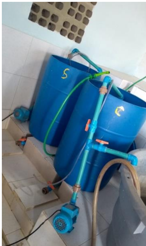
Figura 14: Equipamento improvisado para uso na multiplicação das bactérias na fazenda Top Fruit.
