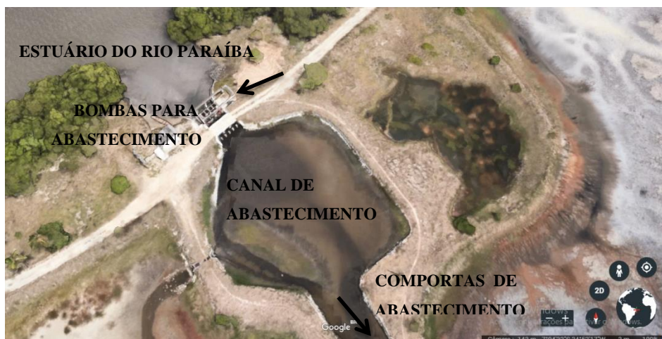
Figura 4 – Imagem aérea do local de captação da água, posicionamento das bombas e do canal de abastecimento da fazenda Camar Aquamaris, João Pessoa – PB.
