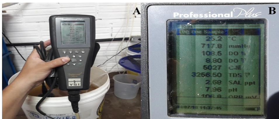
Figura 2. Equipamento multiparâmetro portátil usado no monitoramento da qualidade da água.
