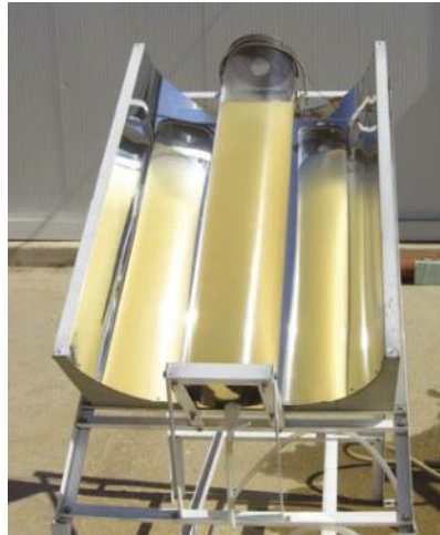
Figura 5 – Sistema de desinfecção solar com coletor parabólico
