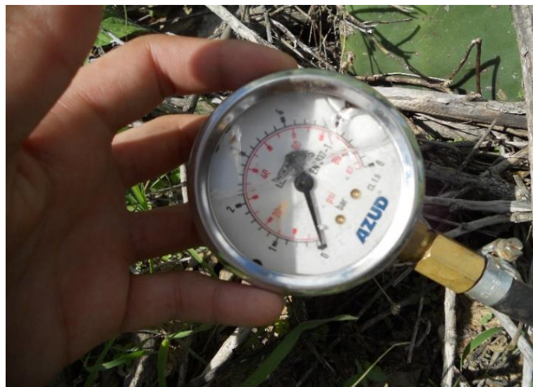
Figura 5: Manômetro instalado na última linha lateral do sistema. Comunidade da Cova do Anjo – Ouricuri / Novembro de 2018.
