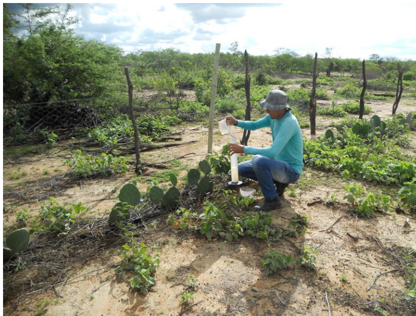
Figura 04: coleta da lâmina de água no sistema de irrigação por gotejamento/ Ouricuri - PE.
