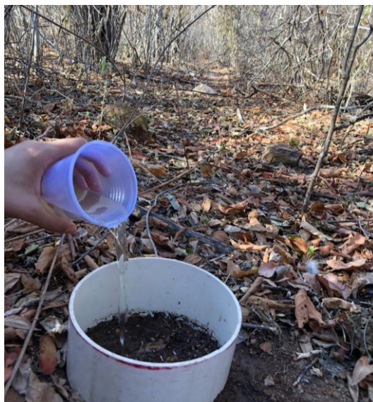
Figura 13: Cilindro utilizado para teste de infiltração. Serra Talhada, 2018.
