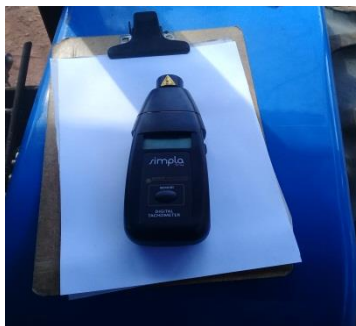
Figura 3 tacômetro digital ótico da marca Simpla modelo TC34.
