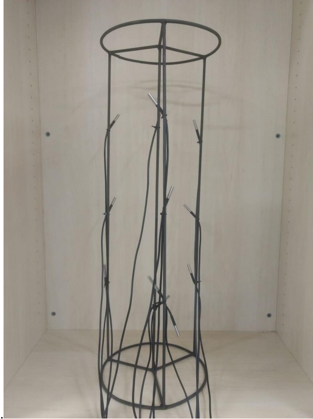
Figura 4 – Estrutura interna do silo com os sensores presos em suas hastes.
