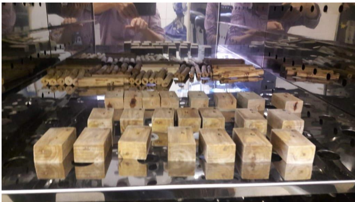
Figura 5. Amostras em estufa a 105\pm 2^{\circ}\text{C} para determinação de umidade.
