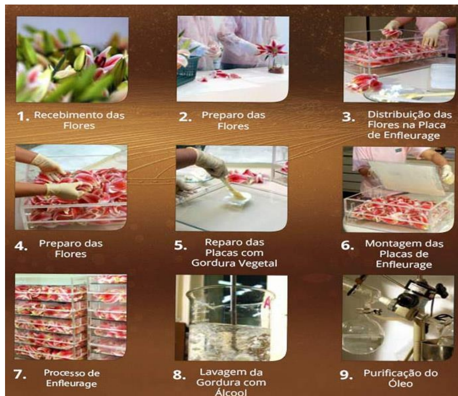
Figura 13: Procedimento para extração de óleos essenciais usando o método Enfleurage.
