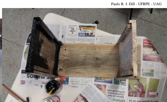
Figura 7 – Visão superior da estrutura de sustentação, formada por tábuas, na fase de pintura.
