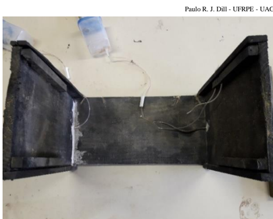
Figura 8 – Maquete após inserção e instalação das mangueiras e dos potes.
