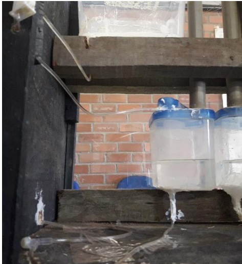
Figura 10 – Posição final dos potes onde o lençol freático (pote inferior) recebe resíduos do esgoto (pote superior), assim representando o esquema da propriedade ambientalmente incorreta.
