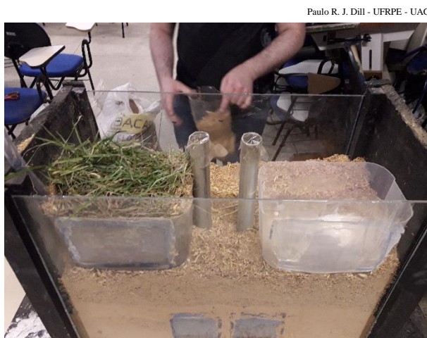
Figura 24 – Pó de serragem em nivelamento com a base das fossas.
