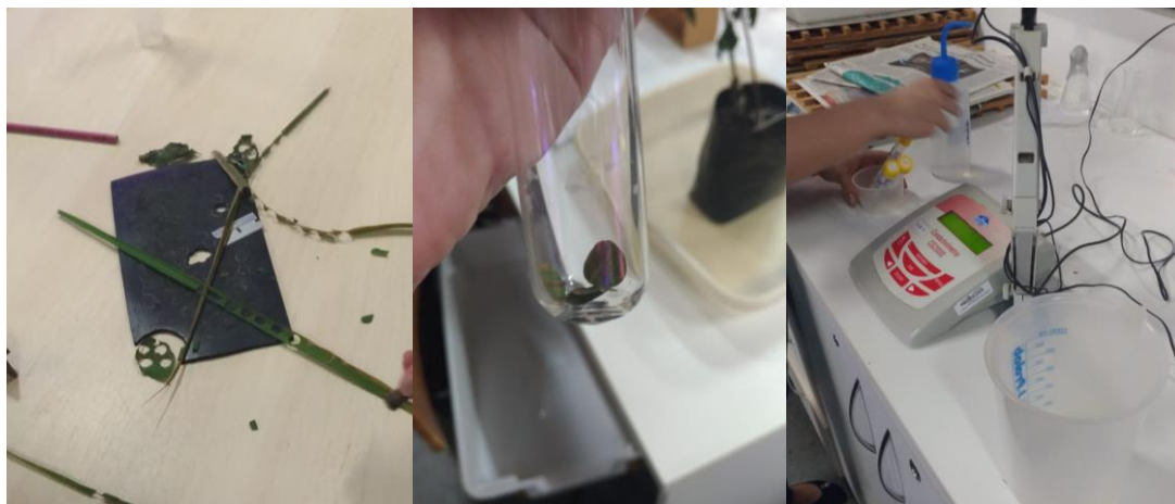
Figura 6. Análise de extravasamento de eletrólitos em plantas de arroz, usando um condutivímetro.
