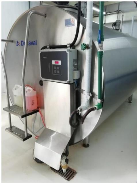
**Figura 18. Tanque de armazenamento do leite**
