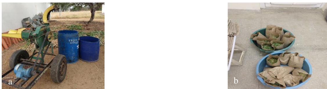
2.6. Figura 6: Material para processamento em picadora (a), para posterior secagem (b) em estufa de ventilação forçada de ar.
