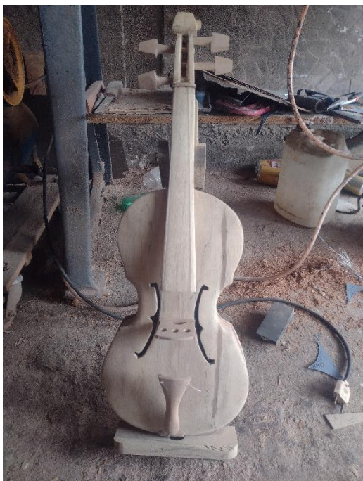
(Figura 13). Caixa de ressonância da rabeca e Braço Fonte: Arquivo pessoal da autora
