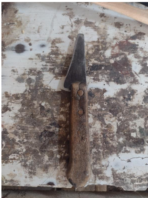
(Figura 15). Faca artesanal para escavar a madeira. Fonte: Arquivo pessoal da autora
