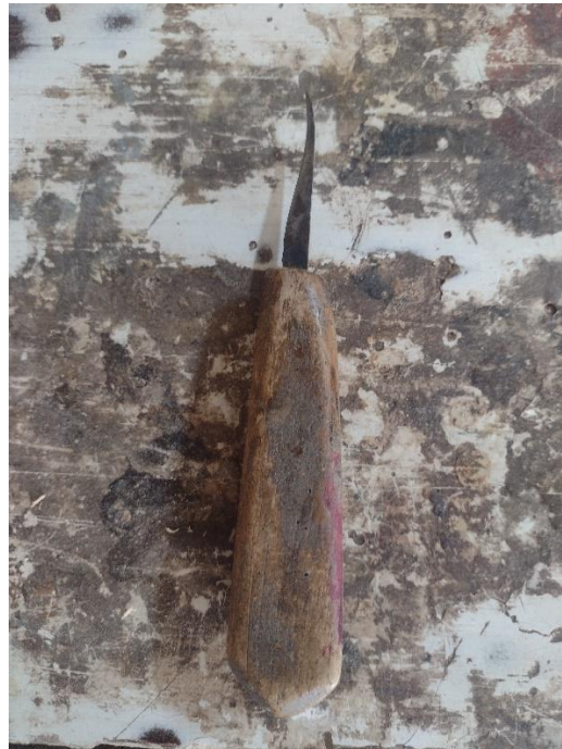
( Figura 16). Facara artesanal utilizada para escavar os F's no tampo superior. Fonte: Arquivo pessoal da autora
