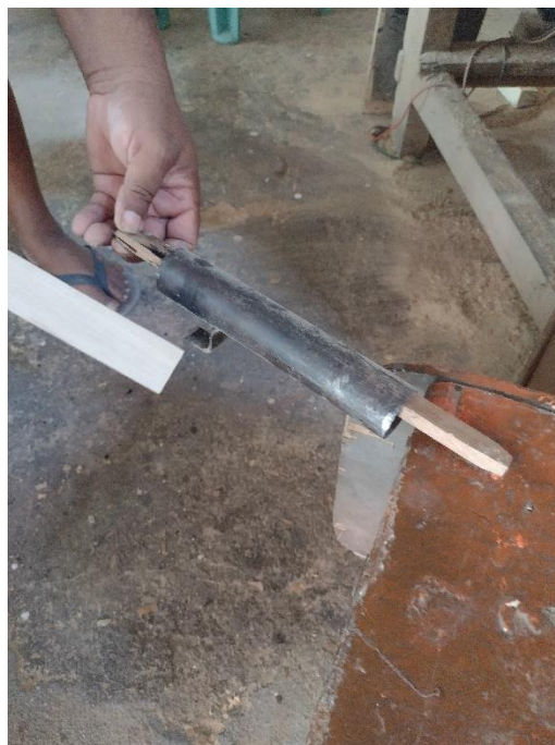
(Figura 18). Cilindo de ferro utilizado para moldar o aro da rabeça. Fonte: Arquivo pessoal da autora.
