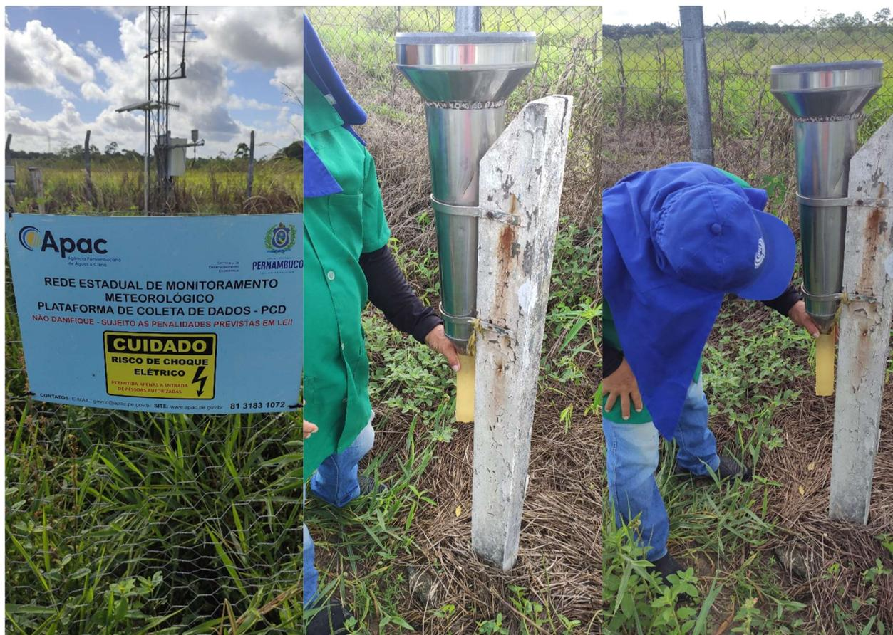
Figura 8, a,b,c- Imagem da Plataforma de retirada da água no pluviômetro para monitoramento das chuvas.
