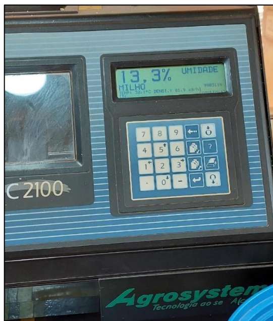
Figura 34. Aferição da umidade de milho.
