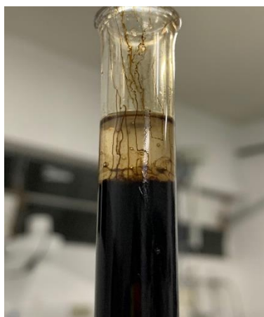
Figura 16. Separação da mistura de óleo e solvente da água do mar em coluna de separação de vidro aberta.
