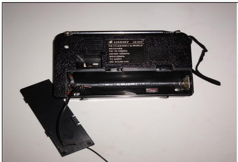
Figura 16: Ligação do terminal negativo da antena ao terminal negativo do rádio.
