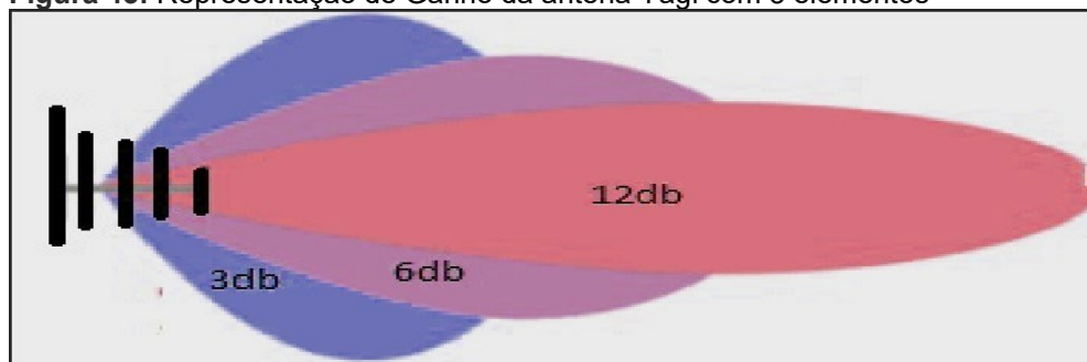
Figura 43: Representação de Ganho da antena Yagi com 3 elementos
