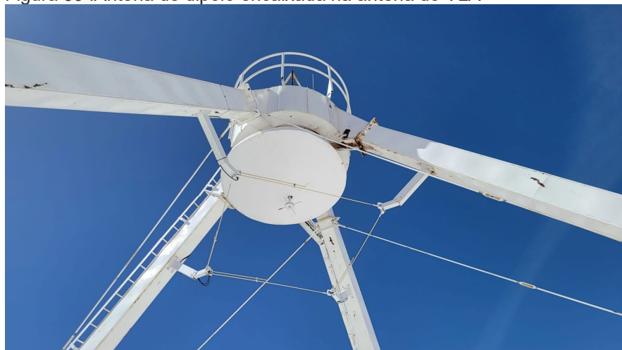
Figura 39 :Antena de dipolo encaixada na antena do VLA
