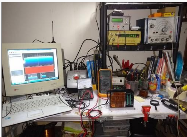
Figura 19: Bancada do autor com instrumentos para a calibração do dial do rádio.
