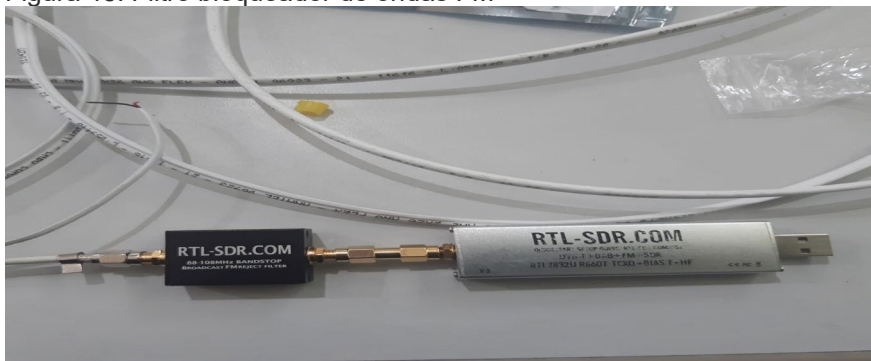
Figura 48: Filtro bloqueador de ondas FM
