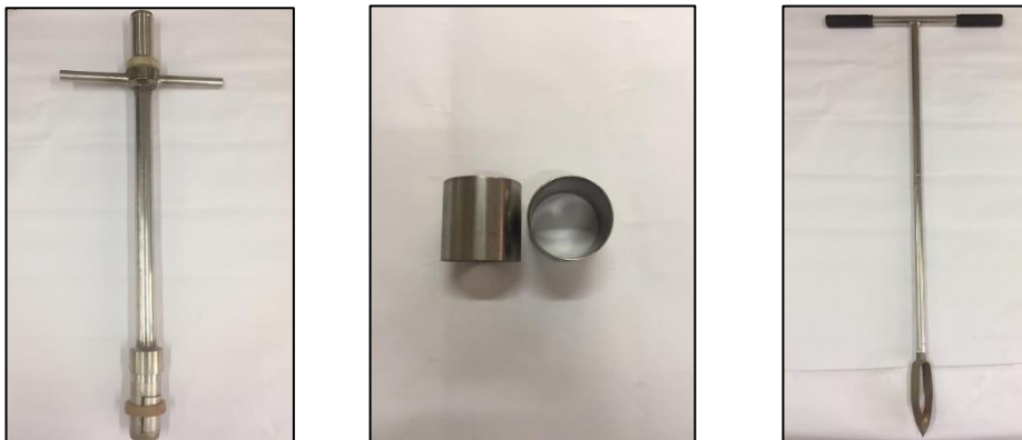
Figura 4. Da esquerda para a direita, trado tipo Uhland, anéis volumétricos, e trado holandês.
