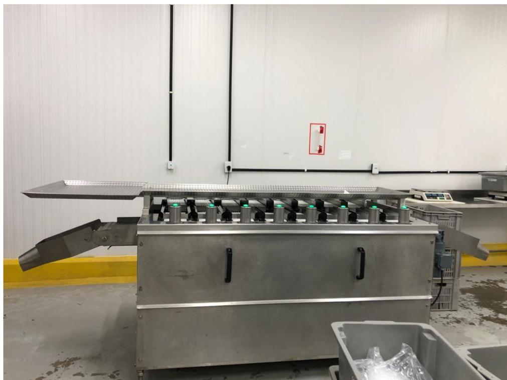
Figura 8. Balança horizontal com múltiplos cabeçotes
