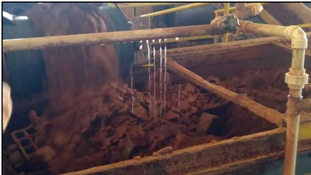
Figura 6 - Processo de mistura do traço com adição de água e material cru não conforme.
