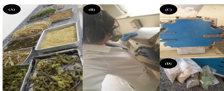
Figura 7. (A) bandejas com as amostras secas em estufas; (B) moagem das amostras; (C) moinho de facas; e, (D) amostras moídas Fonte: (SANTOS, 2018).
