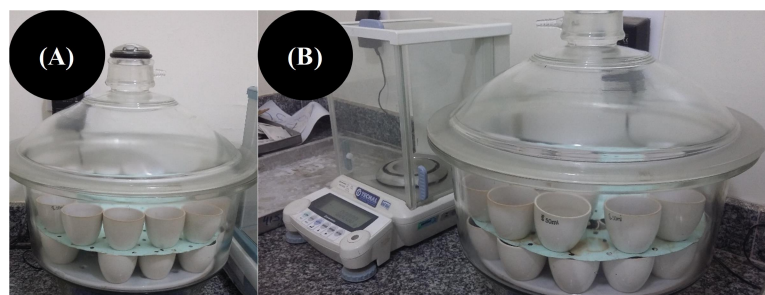
Figura 8. (A) cadinhos no dessecador; e, (B) balança analítica usada para pesar os cadinhos Fonte: (SANTOS, 2018).
