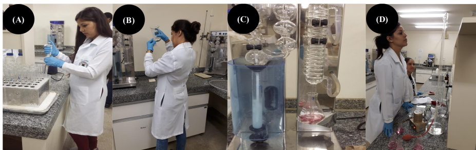
Figura 14. (A) inserção de água destilada nas amostras; (B) medição do hidróxido de sódio para inserção no destilador; (C) destilação; e, (D) titulação da amostra. Fonte: (SANTOS, 2018).
