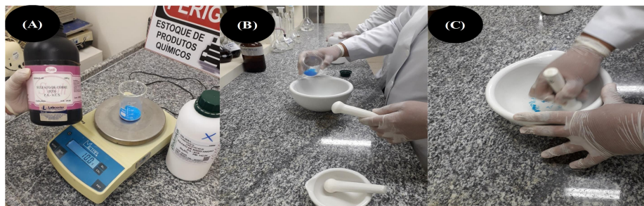
Figura 6. (A) pesagem do sulfato de cobre pentaidratado; (B) grau e pistilo; e, (C) maceração do sulfato de cobre pentaidratado Fonte: (SANTOS, 2018).
