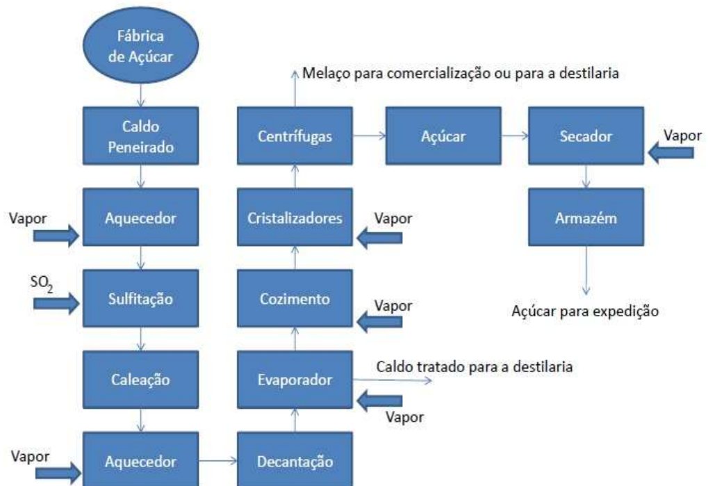
Figura 03 – Cadeia do processo produtivo do tratamento de caldo e produção de açúcar
