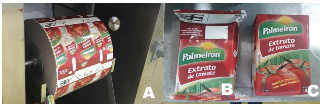
Figura 14: Transformação no formato do material de embalagem
